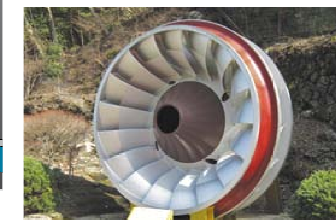
Turbina Francis | Francis-turbine
